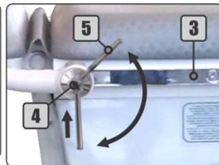
**Nota:** a haste metálica (5) se movimenta somente na área indicada na figura acima. Para girar a haste (5) no sentido horário, empurre-a para cima fazendo com que ela passe por dentro do eixo do manípulo metálico (4), para então girá-la novamente.
