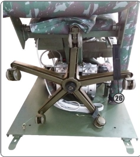
16 - Con la cinta de 40 cm, asegure la base del taburete en la palanca de ajuste del asiento (26) y asegúrese de que las mangueras y el cable eléctrico no se queden sueltos.
