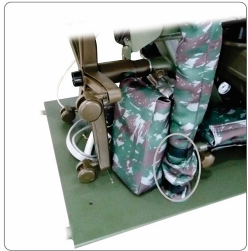
20 - Fije con Velcro® el embalaje de los tanques de agua en el brazo de la lámpara.
