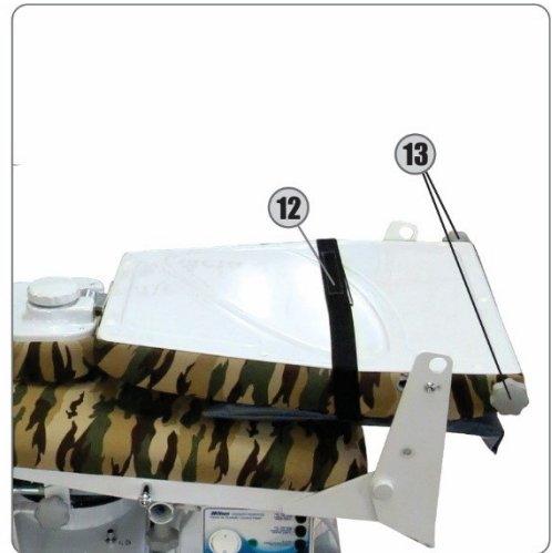
11 - Baje el respaldo, vuelva a colocar los pernos laterales (13) y fije el Velcro® a la bolsa de la bandeja y los instrumentos (12) detrás del respaldo como se indicó anteriormente.
