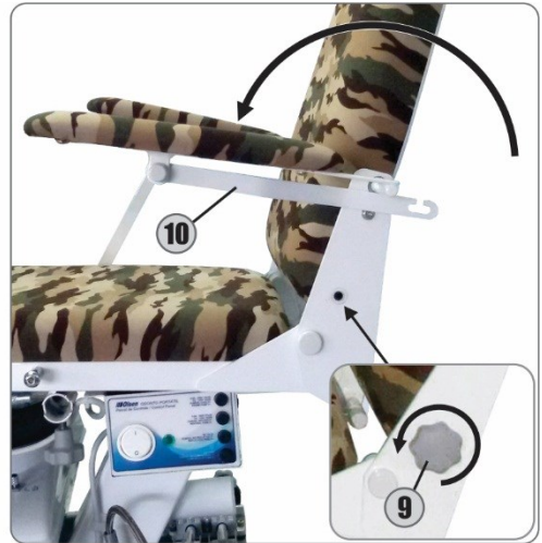
9 - Retire el perno del lado izquierdo del respaldo (9), coloque la barra de metal (10) en paralelo con el apoyabrazos y gire el apoyabrazos en sentido antihorario para retirarlo; Repita la operación con el apoyabrazos derecho.
