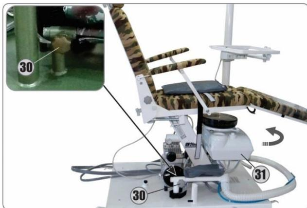
**13**-Afrouxe o manípulo (30) e remova a unidade de água (31), passando por baixo do apoio de pés, para instalá-la em seu suporte na lateral esquerda.
