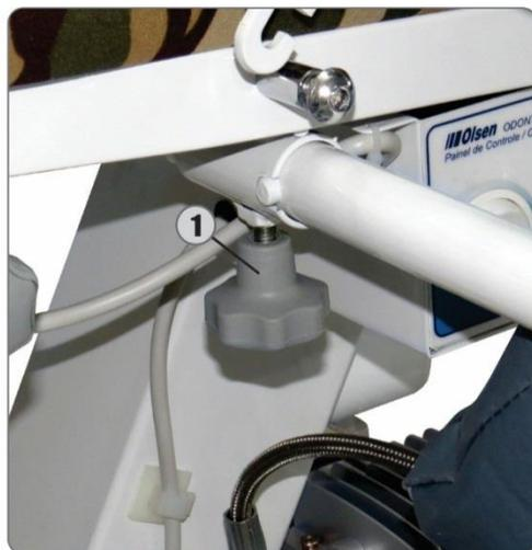
**5-**Solte o manípulo de fixação (1) da unidade de água para removê-la, com as mangueiras e os instrumentos na embalagem; se o equipamento possui fotopolimerizador, desconecte-o e guarde na embalagem da bandeja e instrumentos.
