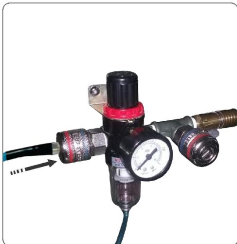
**2-**Desconecte a mangueira de alimentação de ar comprimido do equipamento.
