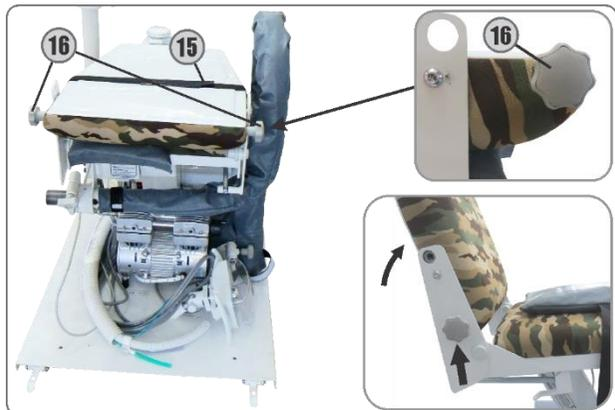
**7-** Solte a fita que está presa no encosto (15), retire os dois manípulos laterais (16). Levante o encosto e encaixe o manípulo da lateral direita apenas para prender o encosto temporariamente.
