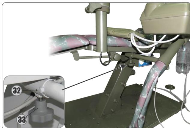
**14**-Encaixe a unidade de água no suporte sob o assento, encaixando o batente (32) no alojamento e então aperte o manípulo (33) para fixação.
