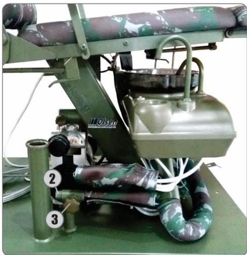
**6**-Passe a unidade de água sob o assento e encaixe-a no suporte (2) na lateral direita do equipamento. Trave o manípulo (3).
