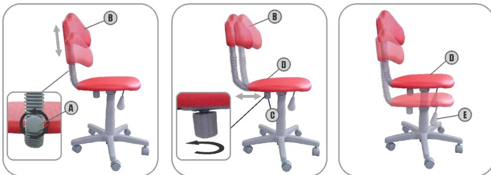
**Para ajustar a altura do encosto (B):** gire o manípulo (A) no sentido anti-horário. Posicione o encosto na altura desejada e aperte o manípulo para travar o encosto na posição.
