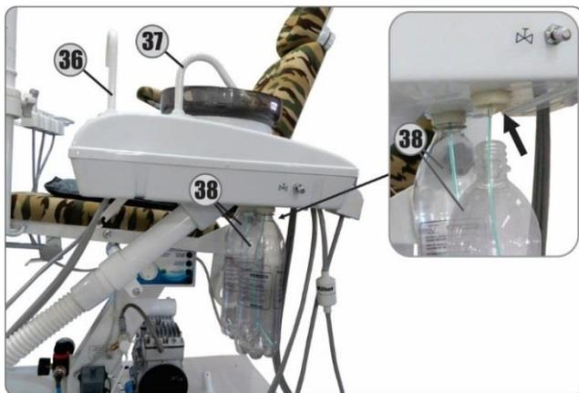
**16**-Instale os dutos do porta-copo (36) e da cuba (37). Coloque água nos tanques (38) e instale-os girando-os em sentido horário para fixação.
