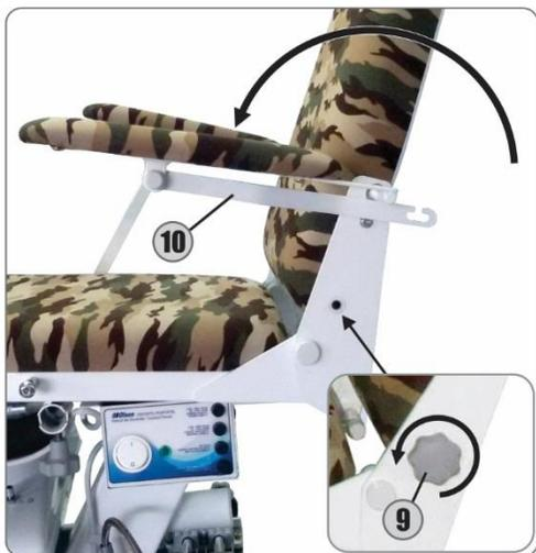
**9**-Retire o manípulo do lado esquerdo do encosto (9), posicione a haste metálica (10) em paralelo com o braço e gire o braço em sentido anti-horário e remova-o. Repita a operação com o braço do lado direito.
