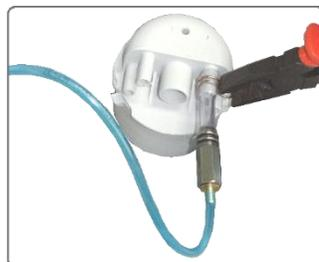
**5**-Conecte a mangueira de desague da válvula Venturi em um dos dutos abertos do conector de esgoto.
