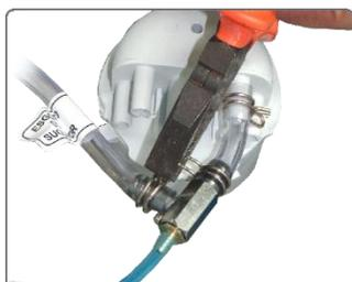
**6**-Conecte a mangueira de ar (6) na válvula venturi. Utilize a abraçadeira de pressão.
