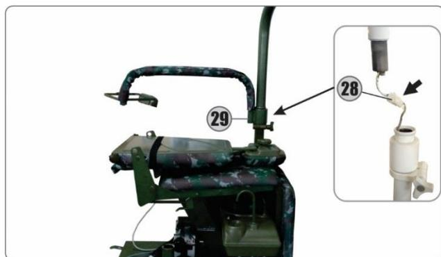
**12-**Conecte o cabo de alimentação do refletor (28) encaixe o braço sobre a coluna (29) tomando cuidado para não danificar o conector durante o encaixe.
