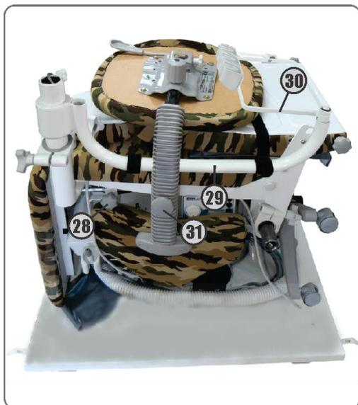
**17**-Encaixe o encosto do mocho sob o manípulo (28), e sobre o braço (29); posicione a estrutura da bandeja (30) sobre o assento do mocho. Remova o parafuso do encosto do mocho (31) e guarde junto com os tanques de água.
