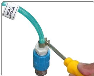
**9-**Conecte a mangueira de água no conector para água. Utilize a abraçadeira com parafuso.
