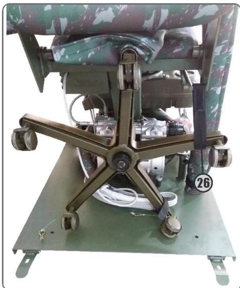
**16**-Com a fita de 40 cm prenda a base do mocho na alavanca de ajuste do acento (26) e certifique-se que as mangueiras e o cabo elétrico não vão ficar soltos.
