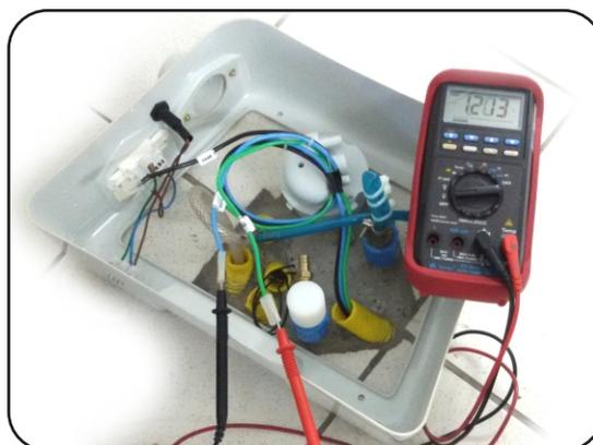
A melhor forma para avaliar o aterramento elétrico é verificando sua impedância. A impedância máxima recomendável para o TERRA da rede local é de 5,0 Ohms, sendo aceitável o limite máximo de 10,0 Ohms, porém a medição deve ser feita com um TERRÔMETRO.
