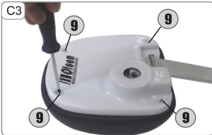
**C3**-Com a chave Philips remover os 4 parafusos (8) de fixação da carenagem.
