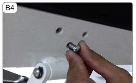
**B4-**Para fixar o novo estofamento, encaixar os parafusos com a mão antes de apertá-los com a chave.
