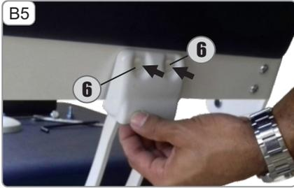
**B5**-Encaixar a tampa do articulador e pressionar os clips (6) para fixá-la corretamente.
