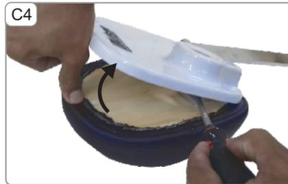
**C4**-Levantar com cuidado a carenagem o suficiente para acessar a presilha (10) da haste.
