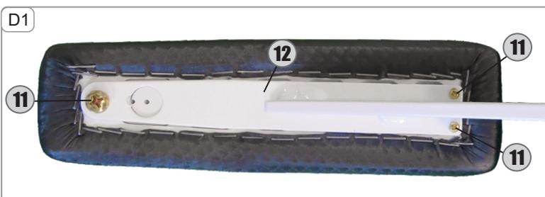
**D1**-Para substituir o estofamento dos apoios de braço, remover os 3 parafusos (11) da parte inferior de cada apoio de braço com a chave Phillips, encaixar os novos estofamentos nas estruturas metálicas dos braços (12) e fixá-los com os mesmos parafusos (11).
