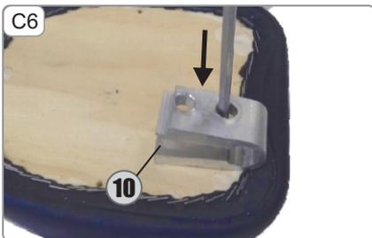
**C6**-Com a chave Philips soltar a presilha (10) do estofamento antigo e instalar no novo estofamento.
