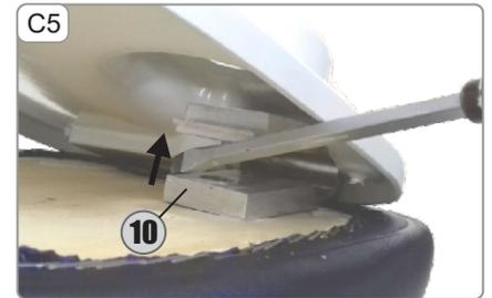
**C5**-Com a chave de fenda forçar a presilha (10) para cima então remover a haste (7) puxando-a para fora da presilha.
