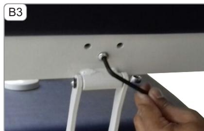
**B3-**Em seguida remover o parafuso central para então retirar o estofamento do encosto.
