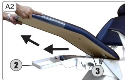
**A2-**Puxar o assento para frente e levantá-lo cuidadosamente para desencaixar as travas posteriores (3) da estrutura do assento (2).
