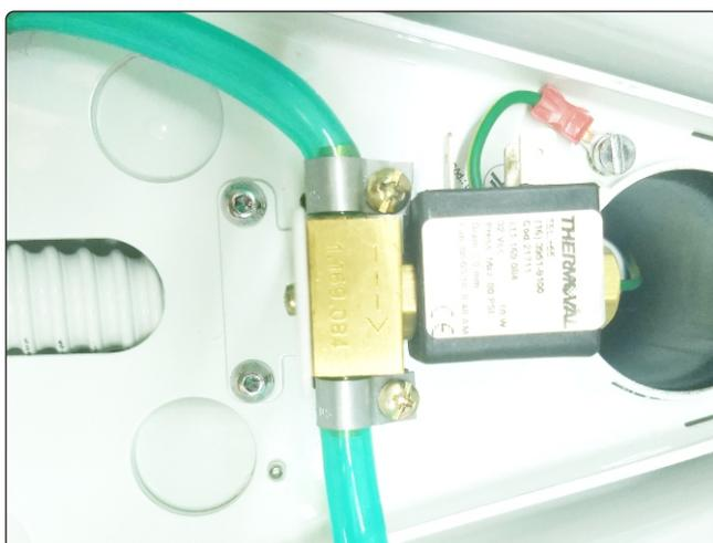
Repare que a diferença entre o suporte antigo e o suporte novo encontra-se na posição como a válvula é fixada, permitindo que os parafusos do suporte fiquem acessíveis.
