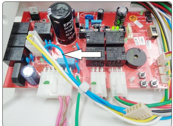
Cabo de comunicação do refletor Premium dobrado e amarrado com abraçadeira, tornando-o inutilizado, e portanto sem conexão com a placa CPU da cadeira.
