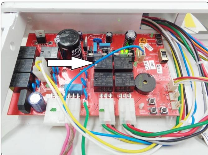
Conexão do cabo de comunicação do refletor Premium com a placa CPU da cadeira.
