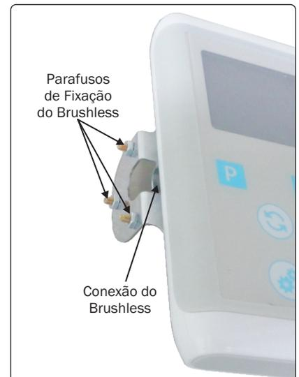
Retire o tempo da mesa odontológica do kart e conecte o micromotor Brushless ao seu conector à mesa. Note que deve conectar com os furos de fixação do micromotor alinhados aos da mesa.
