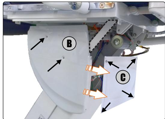
**2º Passo** - Remova a carenagem inferior (B), retirando primeiro a tampa frontal (C) através de 2 parafusos em cima e 2 pinos embaixo. Após retire a carenagem inferior (B) através de 2 parafusos em cada lateral;
