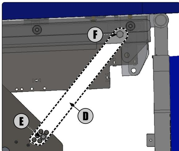
**3º Passo** - Para o ajuste da haste (D) solte o parafuso inferior (E) e afrouxe o parafuso superior (F). Escolha a furação que proporcione a inclinação do assento desejada. Realize esse procedimento com as duas hastes. Então aperte os 2 parafusos (E e F) e reinstale as carenagens.
