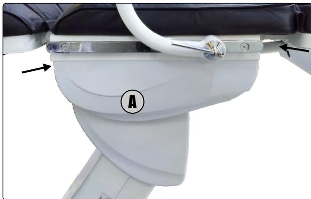
**1º Passo** - Retire a carenagem superior (A) que é fixada por 5 parafusos (3 na frente e 2 atrás);
