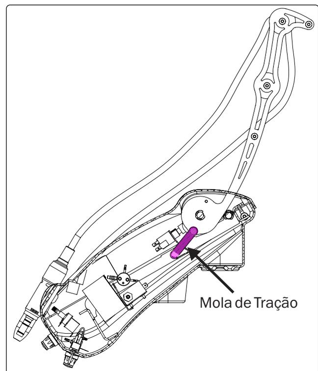
Estas molas são responsáveis pelo acionamento e retorno das hastes com os instrumentos. Dessa forma, para garantir o funcionamento eficiente deve-se utilizar a mola de tração conforme especificado na relação abaixo:
