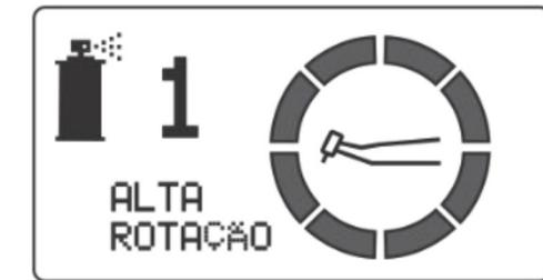
Al retirar la pieza de mano del soporte, el Sistema ChronoLub identificará si el acoplamiento es para baja o alta velocidad, mostrará el número de su posición en la mesa odontológica y un círculo segmentado que representa el tiempo de uso de la pieza de mano. Cuando el último segmento comience a parpadear, significa que la pieza de mano puede usarse por 2 minutos más.
