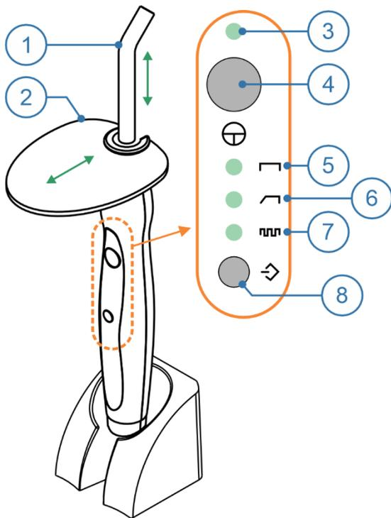
Dispositivo para la polimerización de materiales para restauración y blanqueamiento dental, el fotopolimerizador produce radiación de luz para solidificar resinas sensibles a la luz, con activación de corta duración.
