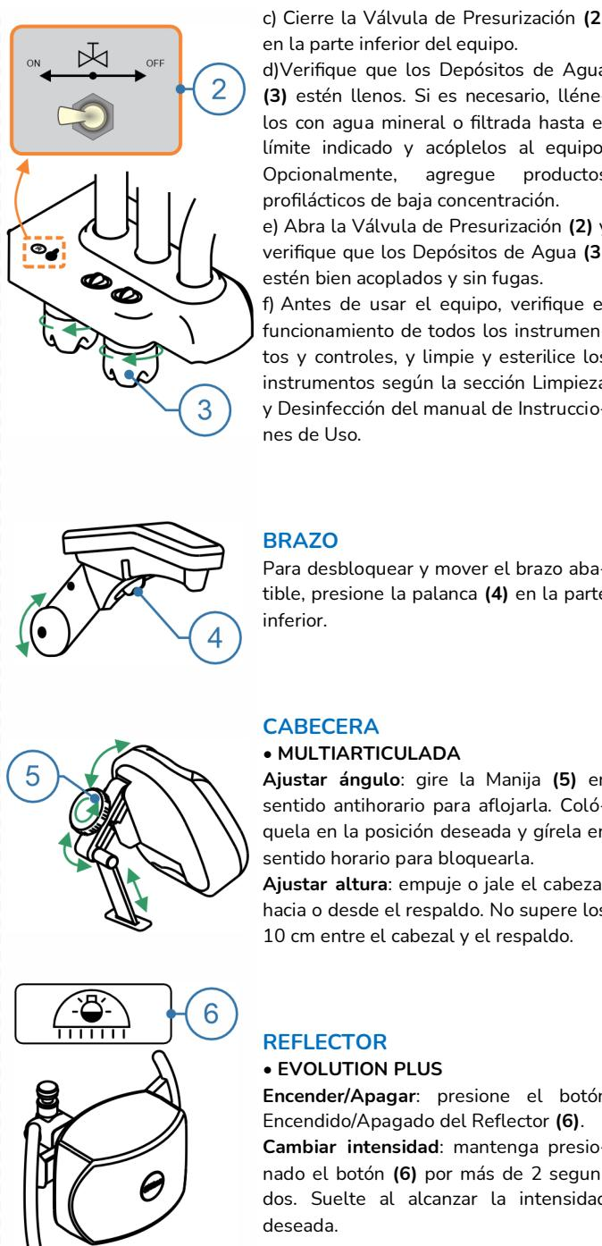
c) Cierre la Válvula de Presurización (2) en la parte inferior del equipo.
